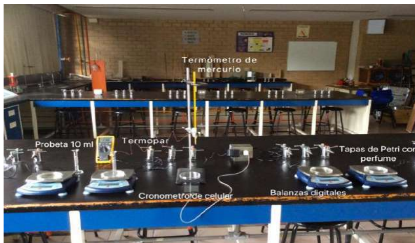
Fig. Arreglo experimental. De izquierda a derecha, la primera balanza contiene muestra económica, la segunda muestra premium, la tercera muestra económica y la cuarta muestra premium. Imagen de elaboración propia, Luis Vázquez (2019)
